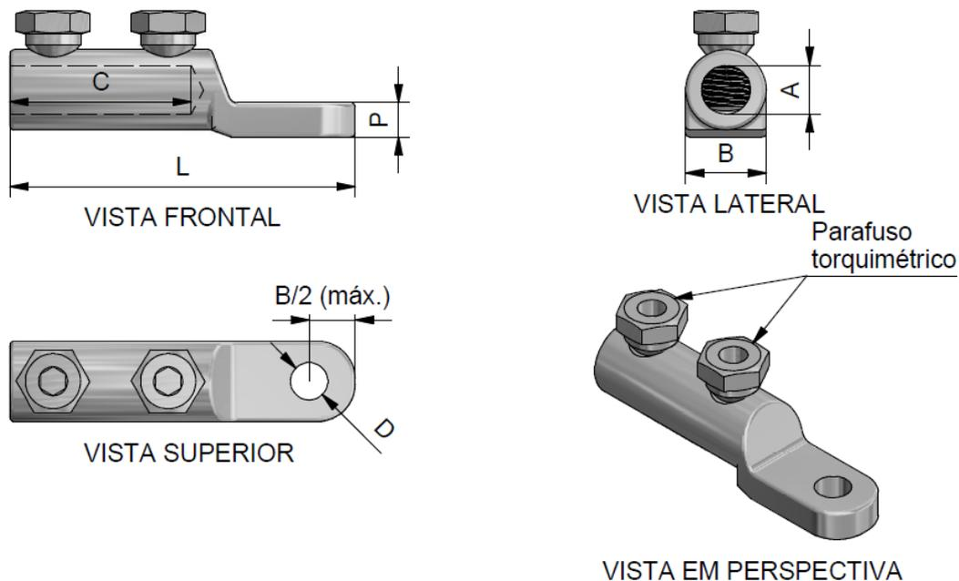
**Figura 1 – Conector Terminal Torquimétrico – Tipo 1**
